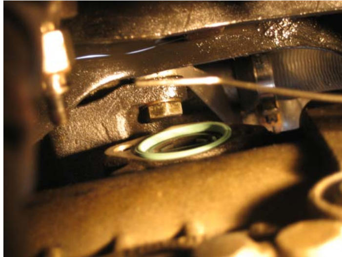
Abbildung 10: neuer Dichtring in Einspritzpumpe eingelegt (Bildquelle: LukasU)
