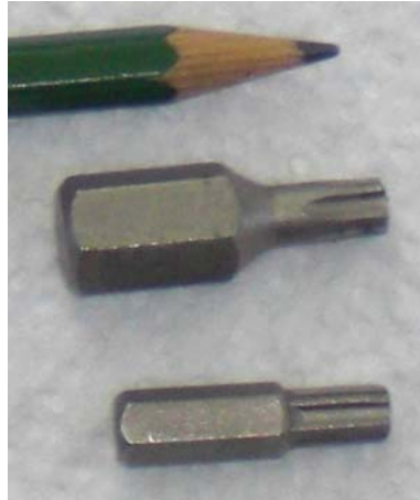
Abbildung 11: Torx TM -Bits, oben Torx TM -Bit Größe T30 mit 3/8“-Antrieb, unten Torx TM -Bit Größe T30 mit 1/4“-Antrieb
