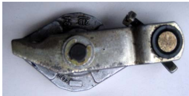
Abbildung 2: kleiner Deckel mit KSB-Welle und Hebel (Bildquelle: LukasU)
