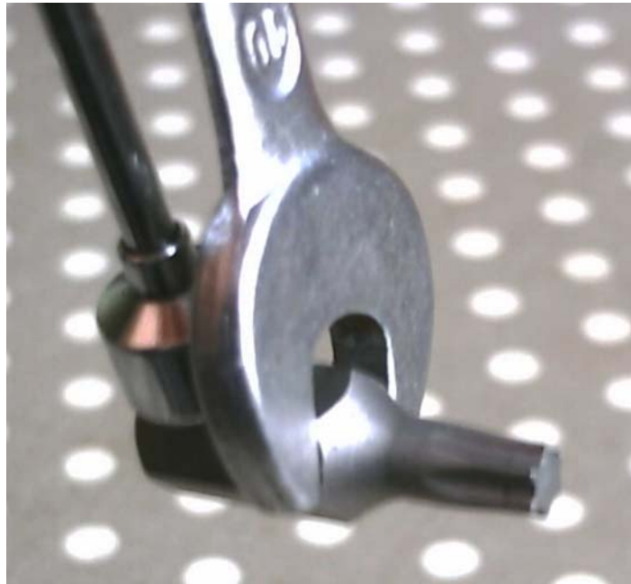
Abbildung 7: „Spezial-Schraub-Technik“: Torx™-Bit mit Maulschlüssel gedreht und durch Magnetstab gehalten
