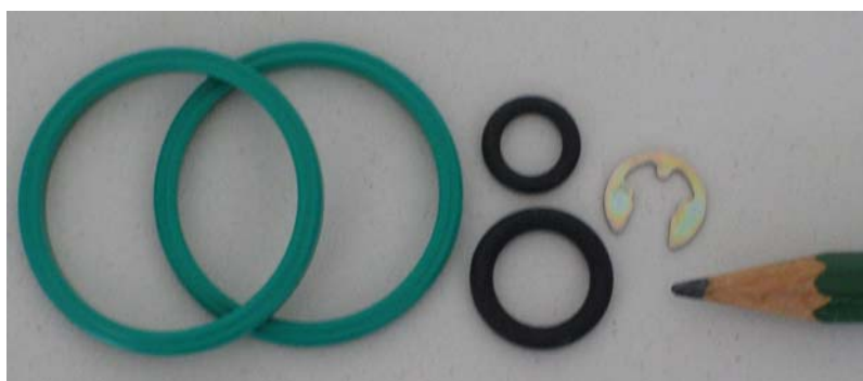
Abbildung 4: Dichtsatz von VW (als Ersatzteilset unter der VW-Ersatzteilnummer 068 198 052 A angeboten) (einige Teile werden nicht benötigt)
